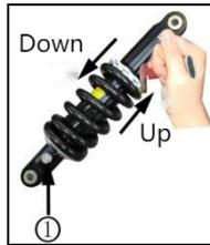
del resorte aumenta y el amortiguador se endurece en su conjunto; cuando el amortiguador se ajusta hacia arriba, la presión previa del resorte disminuye y el amortiguador se ablanda en su conjunto.
