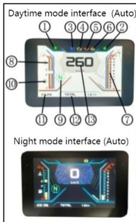
arranca. Si la luz indicadora se apaga después de que la motocicleta arranca, el vehículo está normal y no hay fallo; si la luz indicadora está encendida, habrá un fallo. También en el curso de la conducción, si la luz indicadora está apagada, el vehículo funciona normalmente, si la luz indicadora está encendida, el vehículo debe detenerse y verificar, comuníquese con el departamento de distribución de motocicletas de QJMotor o el centro de mantenimiento para verificar el vehículo a tiempo.
