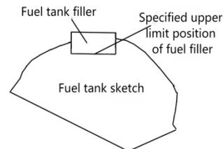
posición especificada del límite superior de reabastecimiento de combustible que se muestra en la siguiente figura, no salpique combustible en el motor térmico, de lo contrario, provocará un funcionamiento anormal de las motocicletas o accidentes peligrosos.
