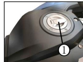
agregar aceite, cuando desee cerrar la tapa del tanque de combustible, dirija el pasador a la tapa del tanque de combustible y luego presione hacia abajo, puede cerrar la tapa del tanque de combustible hasta que se quite la llave cuando escuche el sonido de bloqueo y cierre la cubierta antipolvo de la tapa del tanque de combustible.
