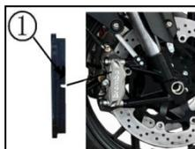
límite 1. Si está rectificada sobre esta marca, debe reemplazarla con una nueva placa de fricción.
