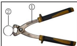
reutilizar y los clips de la placa se pueden reutilizar. Se necesita un clip especial ① para volver a instalar el clip ②, de lo contrario, el ensamblaje del clip no estará en su lugar, lo que provocará un fallo del vehículo.
