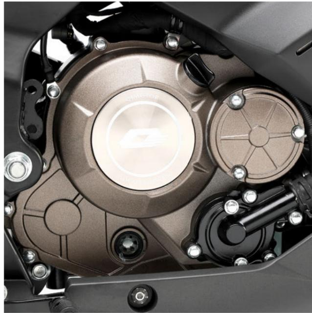
↑ **Motor monocilíndrico 125 cc de 4 válvulas** con refrigeración líquida, con una potencia de 14,9 CV (11 kW) que entrega un par motor máximo de 12,1 Nm a 7.000 rpm contando con un sistema de inyección electrónica.
